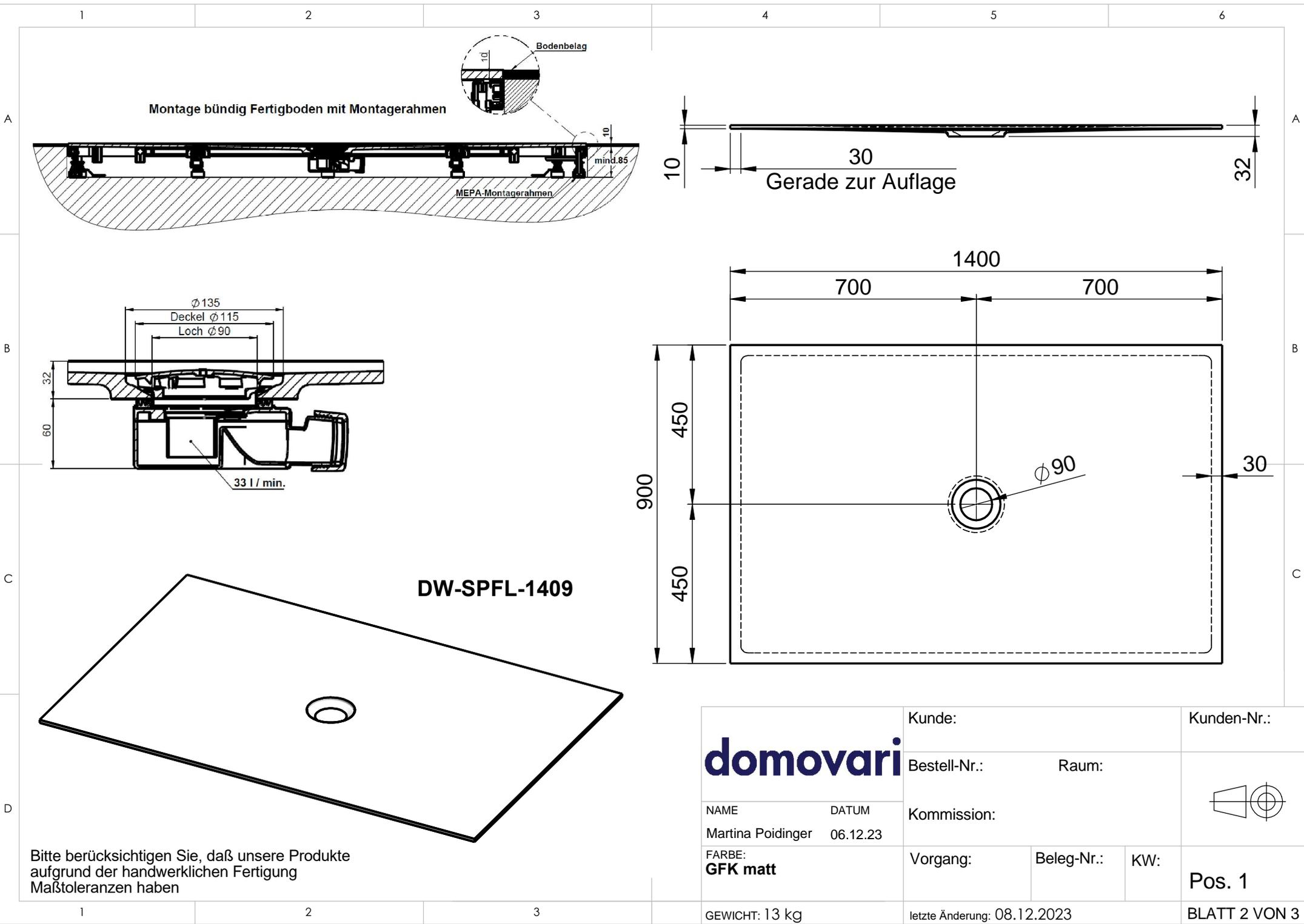
Montage bündig Fertigboden mit Montagerahmen
